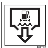
Afvoer wateropvangbak brandstoffilter
