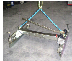
Abbildung und Techn. Daten Universal Dachelementzange HTZ DPK 800N
